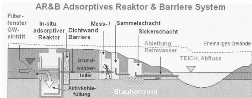
▲ **Peter Niederbacher**, Ingenieurkonsultent für technische Geologie, für das Projekt „AR&B System Brunn a. G.“. Zur Reinigung des Grundwassers von einer alten Industrie-Altlast gelang es Niederbacher, die bestehenden geologischen Verhältnisse optimal zu nützen. Die Innovation dabei ist, dass der normale Grundwasserfluss ausreicht, um das kontaminierte Wasser durch die eingebauten Großfilter zu drücken.
